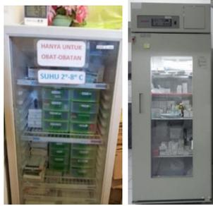
Gambar 1. Lemari pendingin dengan termometer eksternal (kiri) dan lemari pendingin dengan termometer internal (kanan)
